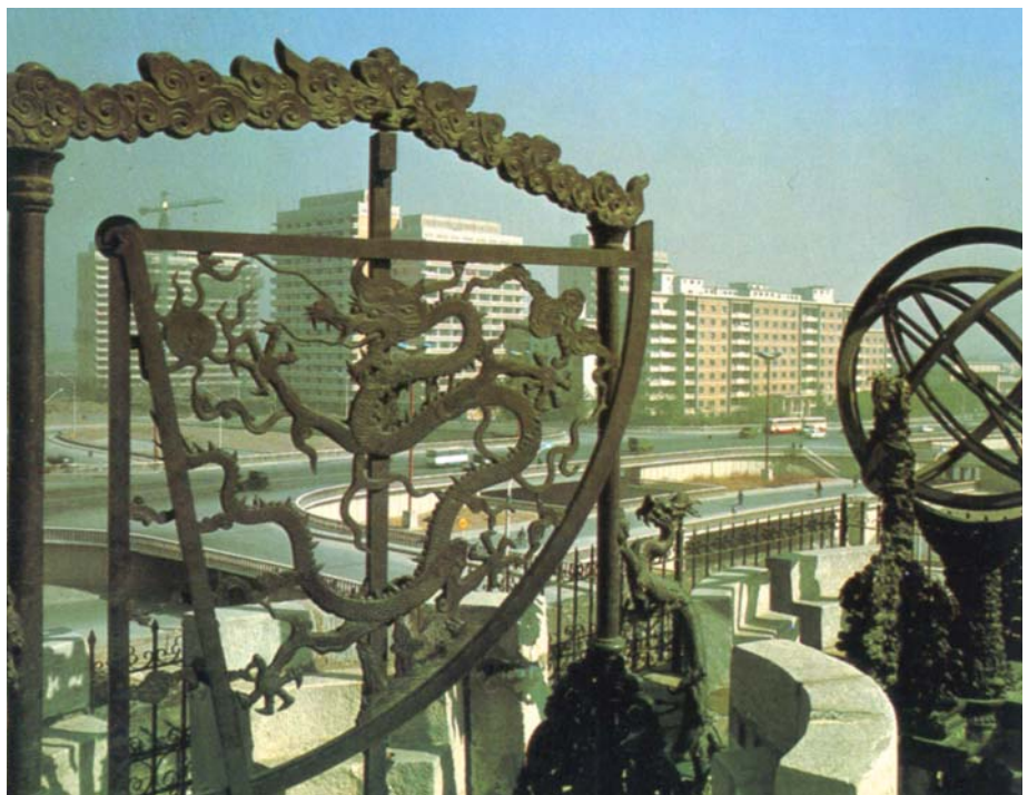
北京古觀象台 始建於元代，由郭守敬、王珣設計，圖中象限儀（清康熙12年）為測定天體地平高度和天頂距。
