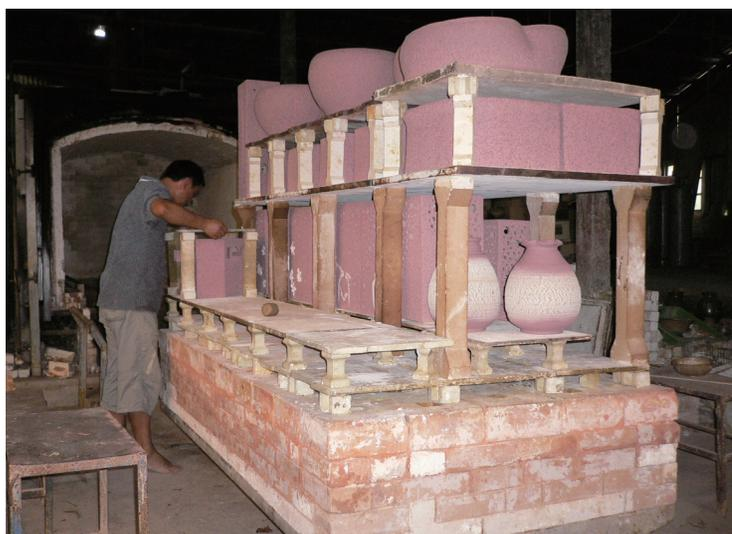
圖5-26 台車式瓦斯窯／苗栗金龍窯
