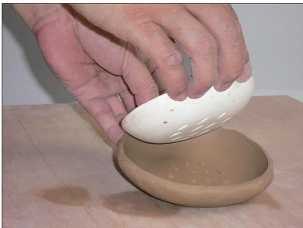
圖5-12 利用石膏模壓模成形
