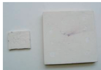
圖8-22 小耐火板、耐火磚
