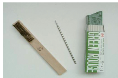
圖8-29 銅刷、壓光棒、青土
