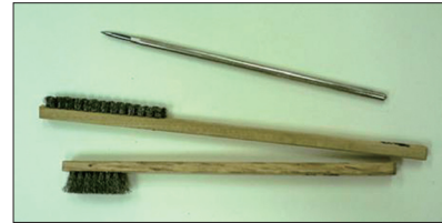
圖8-45 不鏽鋼刷、壓光棒
