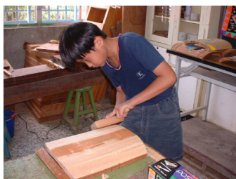
利用手推刨刀修飾弧度
