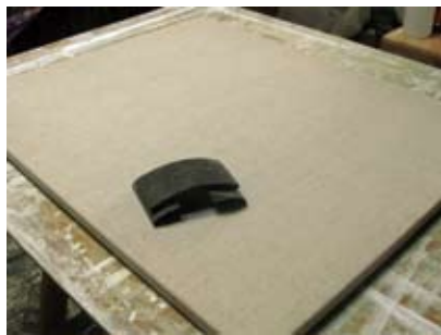
刷第二層膠液，上膠前需先用砂紙以旋轉的方式打磨。
