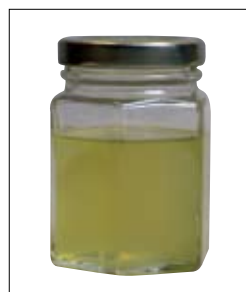
達瑪脂溶化後，過濾掉雜質，達瑪凡尼斯製作完成。
