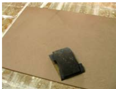
使用砂紙在板子正反面的光澤面磨掉。
