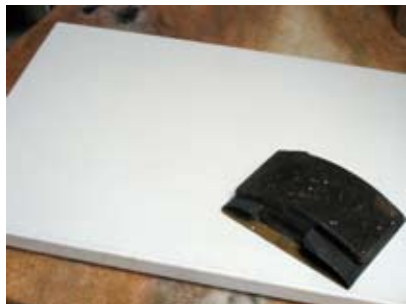
待乾了，使用中目砂紙打磨。
