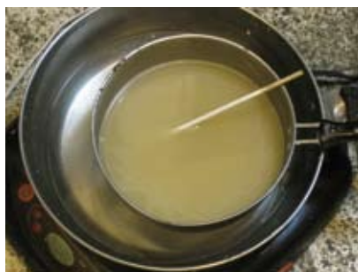
隔水加熱的方式溶解免皮膠。
