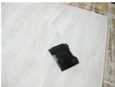
每塗完一層，乾了以後仍要用砂紙小心打磨。
