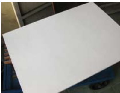
刷完打底劑的板子，要置於陰涼處晾乾。
