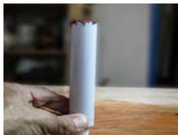
以手輕握軟管，頭朝下，稍為震動幾下，將材料往下填實。
