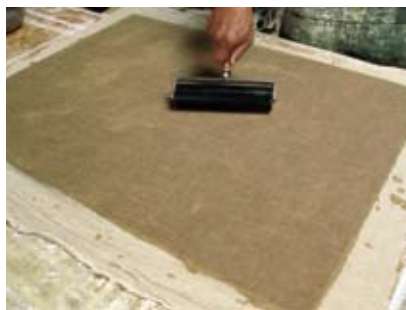
使用滾輪，將胚布和底板中間的空氣壓出。
