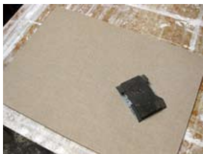
等膠液乾了以後，先用砂紙輕輕的打磨。
