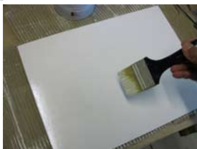
上第二層醇酸樹脂打底劑和塗第一層的反方向塗刷。
