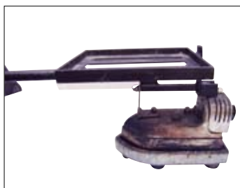
加壓型熨斗（用於古典大型畫作），上面托盤為放置重物。
