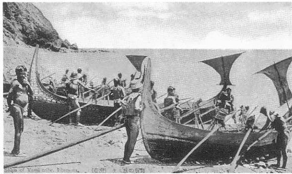
雅美人的「大船」，是指三對槳、四對槳或五對槳的船。這是紅頭嶼造型獨特的大船。（日據時期明信片）
