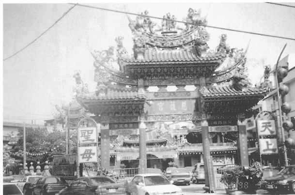
2-16 金山慈護宮山門上有三層 四柱三門七樓牌樓上有剪 黏交趾陶裝飾
