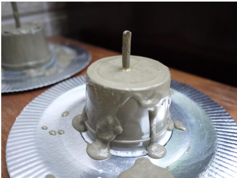
靜置 24 小時後即可拆模。拔掉筷子，用尖嘴鉗去除內外層免洗餐具的部份，用砂紙磨平盆口與盆底後，沖水洗淨並泡水去鹼 24 小時，最後拿出洗淨陰乾
