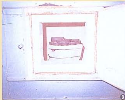
▲脫型法製作過程 ①②原形製作 ③—⑤鑄型製作 ⑥ 彩色玻璃和化學糊調合填塞於圖案位置 ⑦⑧填塞滿玻璃粉 ⑨ 加重壓物一起放進電氣爐內燒製
