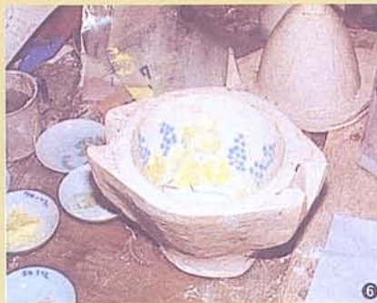
▲脫型法製作過程 ①②原形製作 ③—⑤鑄型製作 ⑥ 彩色玻璃和化學糊調合填塞於圖案位置 ⑦⑧填塞滿玻璃粉 ⑨ 加重壓物一起放進電氣爐內燒製
