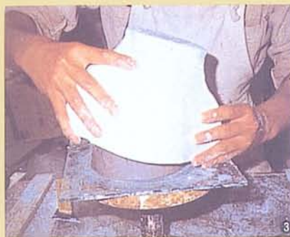
▲脫型法製作過程 ①②原形製作 ③—⑤鑄型製作 ⑥ 彩色玻璃和化學糊調合填塞於圖案位置 ⑦⑧填塞滿玻璃粉 ⑨ 加重壓物一起放進電氣爐內燒製
