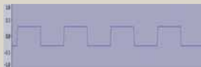
圖4B 早期電子樂器模擬的豎笛波形(方波)
